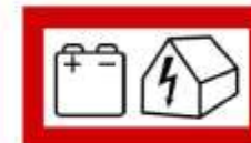
Abbildung 3: Hinweischild Speichersystem ohne Eigenverzeugungsanlage gemäß VDE-AR E 2510-2 (in Analogie zu AGBF-DFV Fachempfehlung 2021-02 Brandschutz bei Lithium-Ionen-Großspeichersystemen)
