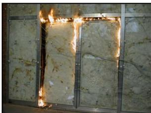
Brandprüfung einer Feuerschutztür T 30-2 mit Seitenteilen und Oberlicht
